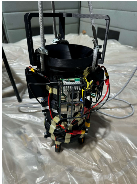
FIGURE 40: Zdjęcie przedstawiające stanowisko do badania właściwości dynamicznych aktuatorów.
