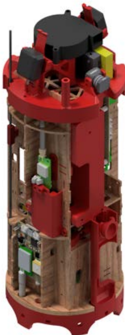
RYSUNEK 14: Model kosza awionicznego w rakiecie HEXA 5
