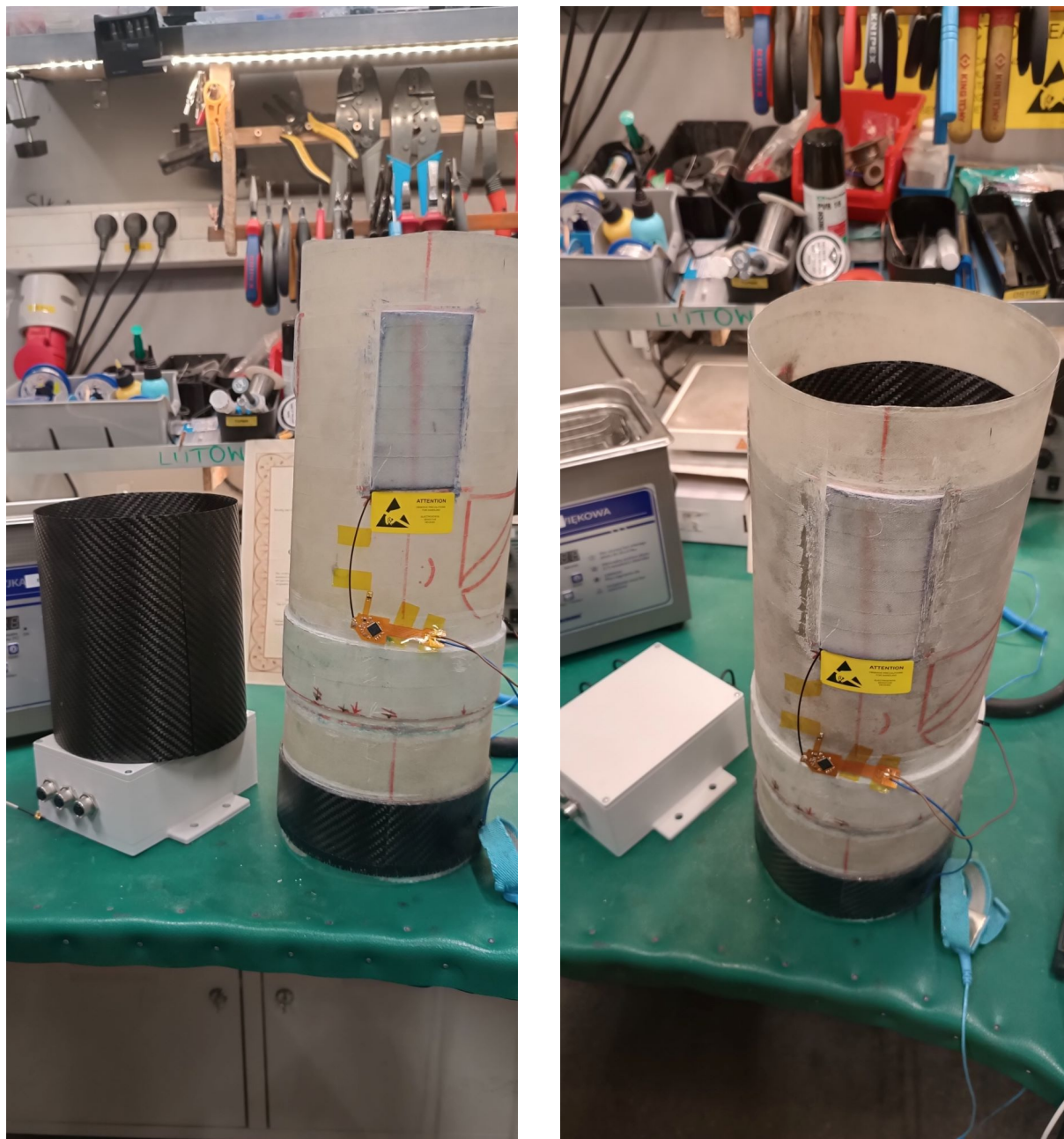
RYSUNEK 36: Porównanie konfiguracji pomiarowych: próbka referencyjna oraz z wkładką węglową
