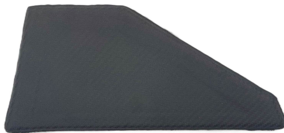
RYSUNEK 19: Prefabrykat płyty statecznika, wykonanego z CFRP z przekładką z pianek strukturalnych na bazie polimeta-krylimidu (PMI)
