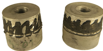
(C) Połączenia klejone o grubości spoiny 0.4 mm po zerwaniu. Zdjęcie przedstawia próbki o skrajnych wytrzymałościach 6.5 kN (po lewej) oraz 20.3 kN (po prawej)
