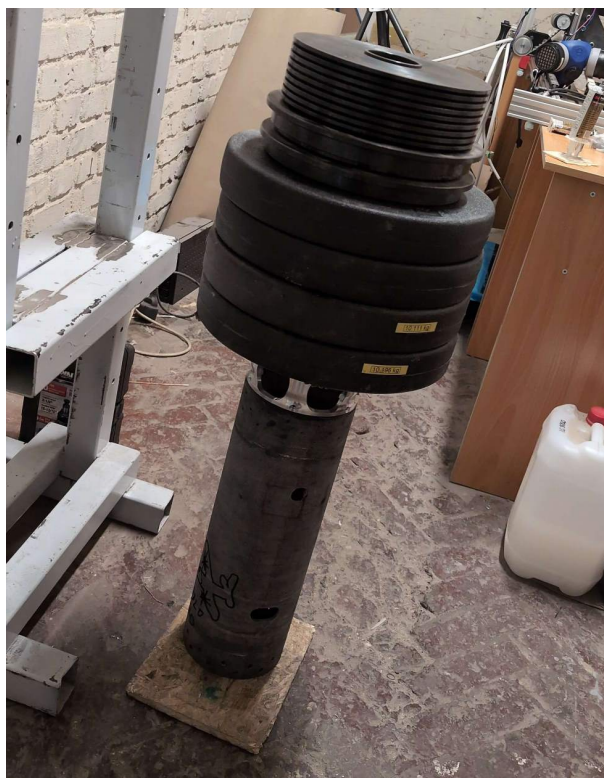
RYSUNEK 13: Dociążanie świeżo sklejonego przedziału awionicznego
