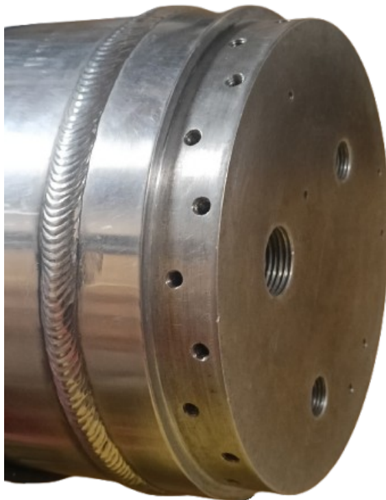
RYSUNEK 4: Połączenie walcowe rozłączne w rakiecie Hexa 2
