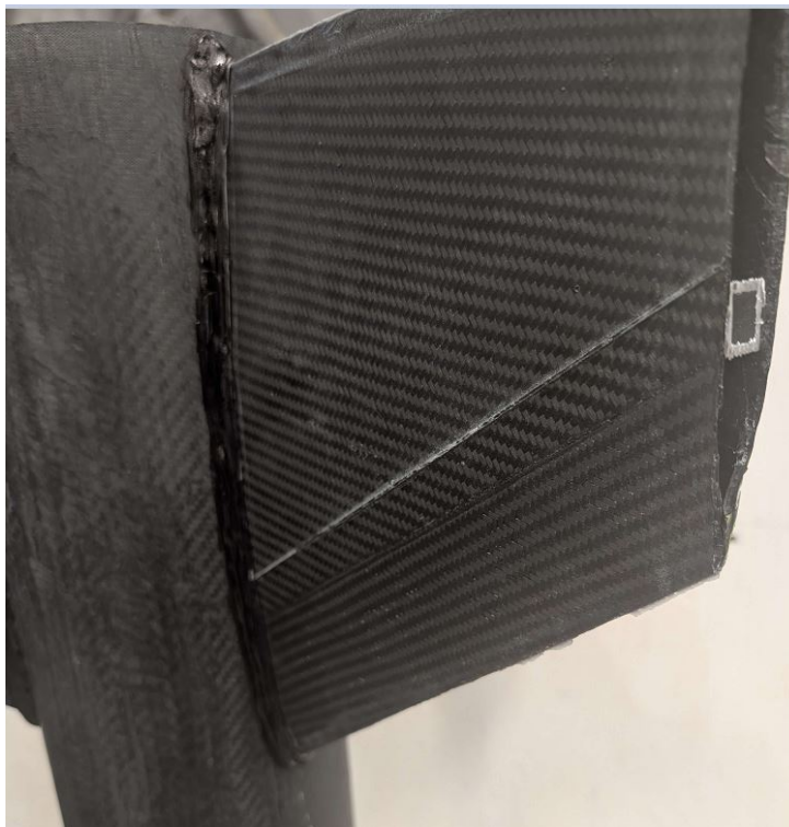
RYSUNEK 24: Montaż klejony do rury kompozytowej fincana w formie monokoka - próbka technologiczna
