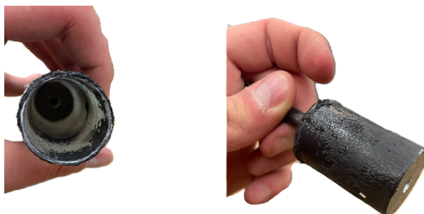
RYSUNEK 6: Zerwana próbka połączenia klejonego dwóch powierzchni walcowych
