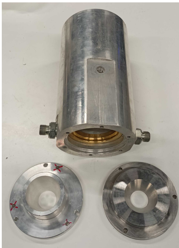
RYSUNEK 41: Inercyjnie chłodzona wersja komory spalania przeznaczona do testów zapłonu
