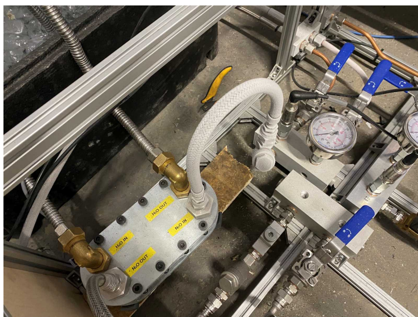
RYSUNEK 11: Wymiennik ciepła w trakcie pracy
