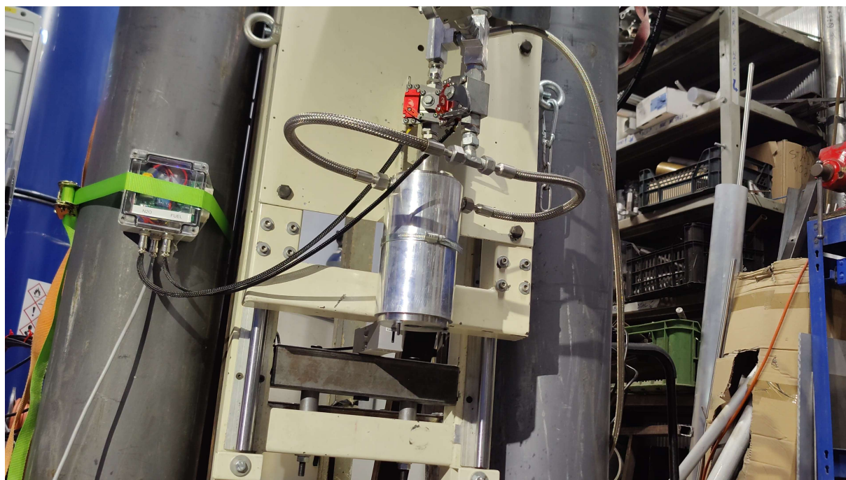
RYSUNEK 38: Stanowisko testowe do testów "na zimno" silnika na paliwa ciekłe
