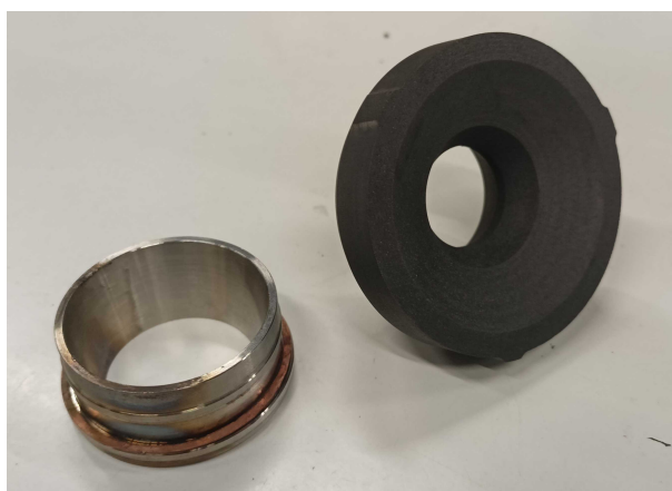
RYSUNEK 27: Graftowa wkładka dyszowa oraz część rozbieżna dyszy wykonana ze stali
