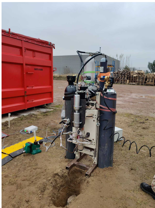
RYSUNEK 43: Stanowisko testowe do testów palnych silnika na paliwa ciekłe - konfiguracja ze zbiornikami małej pojemności do testów zapłonu
