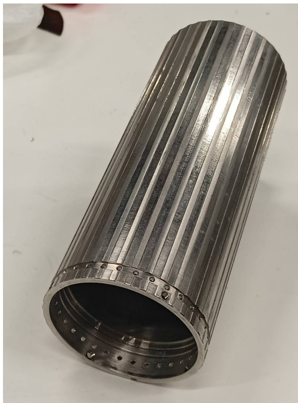
RYSUNEK 25: Stalowa wkładka z widocznymi nafrezowanymi na niej kanałami
