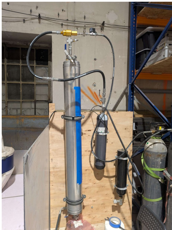
RYSUNEK 12: Stanowisko testowe do badań regulatorów
